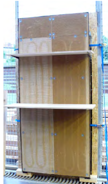
WEM earth radiant panels - Armadillo Box® test before final production at GAIA. Panneaux radiants en terre test pour l'Armadillo Box® avant réalisation finale aux GAIA
