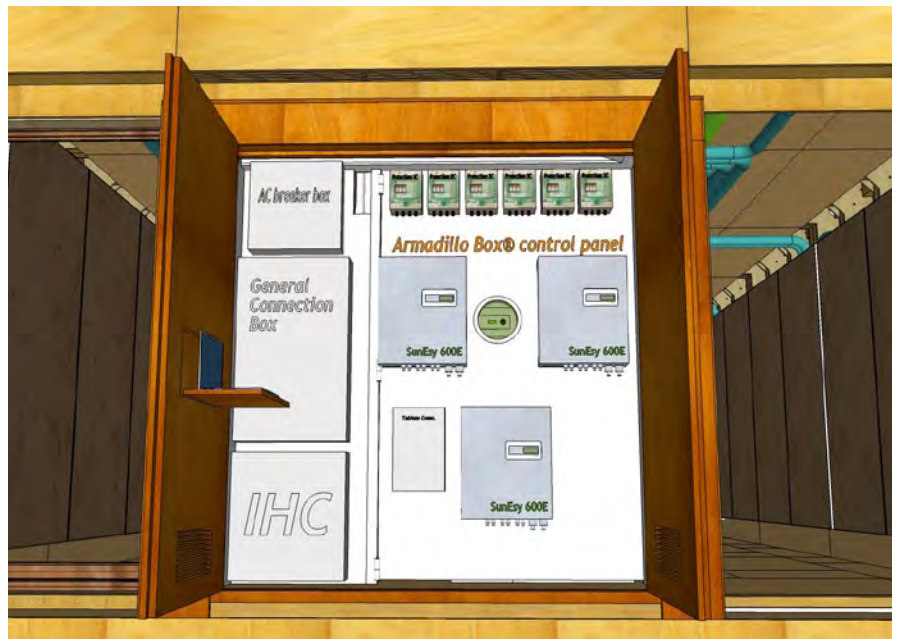
Fig 2 et 3. Accès de maintenance au bloc technique par l'arrière. Tableau électrique en position fermé et ouverte devant la NILAN VP18.
