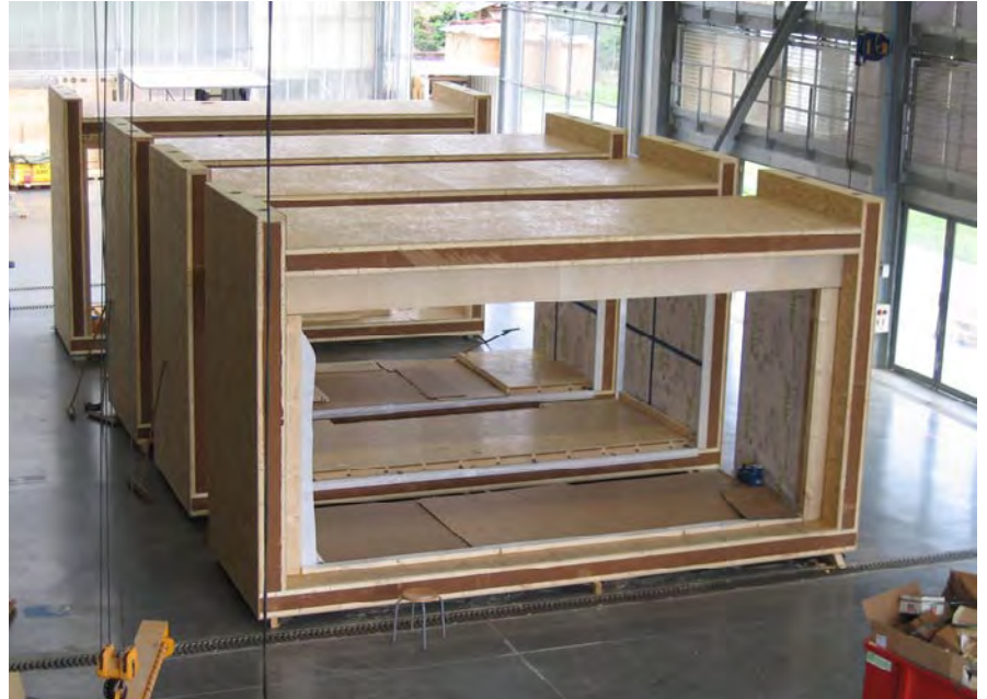
Photos 8. SKIN - Views of ring sections under assembly at GAIA SKIN - Enveloppe isolante. Vue des anneaux en cours d'assemblage aux GAIA
