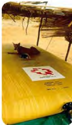
Stockage d'eau potable 5m 3
