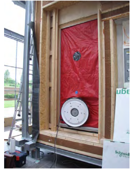
Photos 11. SKIN - Views of bay windows and BlowerDoor test at GAIA SKIN - Enveloppe isolante. Mise en place des baies vitrées et «test blower door» aux GAIA
