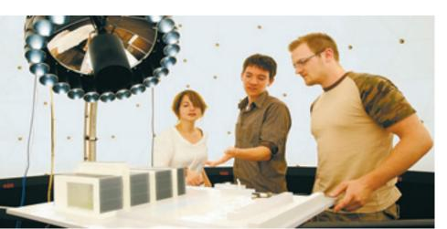
Bis das Solarhaus gebaut ist, testen die Studenten das Modell unter einer künstlichen Sonne. Die dunklen Flächen sollen einmal mit Fotovoltaikfolien überzogen werden. Foto: HfT
