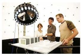
Bis das Solarhaus gebaut ist, testen die Studenten das Modell unter einer künstlichen Sonne. Die dunklen Flächen sollen einmal mit Fotovoltaikfolien überzogen werden. Foto: HfT
