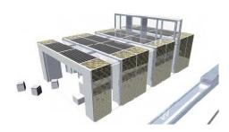
deckung von Spitzenlasten vorgehalten wird. Diese Kombination aus PV-Modul und »Kälte-Kollektor« haben wir an der HFT entwickelt. Der modulare Aufbau des Gebäudes ermöglicht die Weiterentwicklung zu einem Bausystem.
